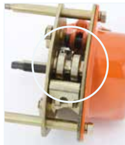
Fini spécialisé des pièces internes offrant une résistance supérieure à la corrosion
