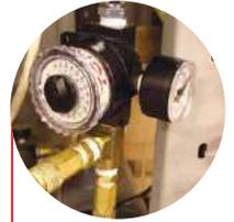
Le régulateur à cadran **QUICK-SET** est idéal lorsque l'opérateur doit régulièrement ajuster la pression (voir page 235)
