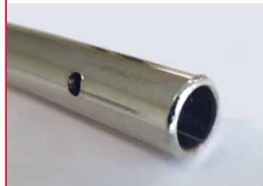
En cas d'obstruction de l'extrémité de la buse, tout le jet d'air est détourné vers les ouvertures latérales et la pression statique est maintenue à moins de 30 PSI (répond aux standards OSHA).
