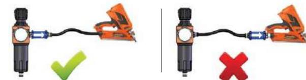
La soupape de sécurité **HOSEGUARD®** doit être installée à l'extrémité du tuyau rigide à air comprimé
