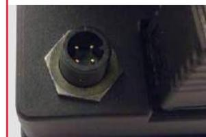
Contact d'alarme sec - Le purgeur est équipé d'un cycle d'alarme spécial qui commence à fonctionner en cas de problème
