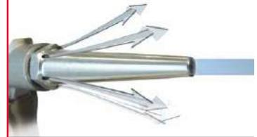
En cas d'obstruction de l'extrémité de la buse, tout le jet d'air est détourné vers les orifices autour de la buse et la pression statique est maintenue à moins de 30 PSI (répond aux standards OSHA)
