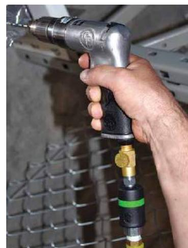
Voir vidéo « Connexion ergonomique d'un outil à air » sur [TOPRING.com](http://TOPRING.com)
