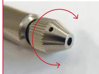
En cas d'obstruction de l'extrémité de la buse, tout le jet d'air est détourné vers les ouvertures latérales et la pression statique est maintenue à moins de 30 PSI (répond aux standards OSHA).
