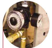
Le régulateur à cadran **QUICK-SET** est idéal lorsque l'opérateur doit régulièrement ajuster la pression (voir page 235)
