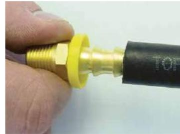
Pour remplacer un raccord « LOCK-ON », simplement couper le tuyau droit et insérer le raccord autobloquant « LOCK-ON ».
