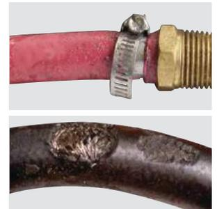
Les fluides transportés ou en contact avec le tuyau doivent être compatibles avec son matériau (air, eau, acides, huiles, vapeur, etc.). Dans certains milieux ceci peut être un élément critique (exemple : fabrication alimentaire, produits pétroliers, etc.)
