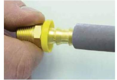
Pour remplacer un raccord « LOCK-ON », simplement couper le tuyau droit et insérer le raccord autobloquant « LOCK-ON ».
