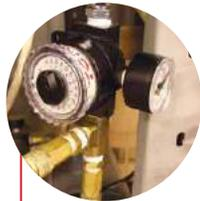
Le régulateur à cadran **QUICK-SET** est idéal lorsque l'opérateur doit régulièrement ajuster la pression (voir page 235)
