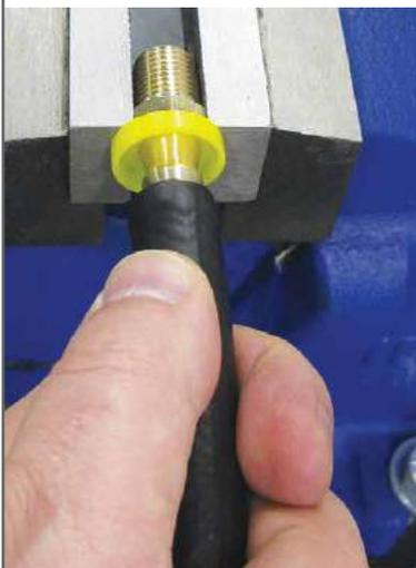
Pour remplacer un raccord « LOCK-ON », couper le tuyau droit et insérer le raccord autobloquant « LOCK-ON »
