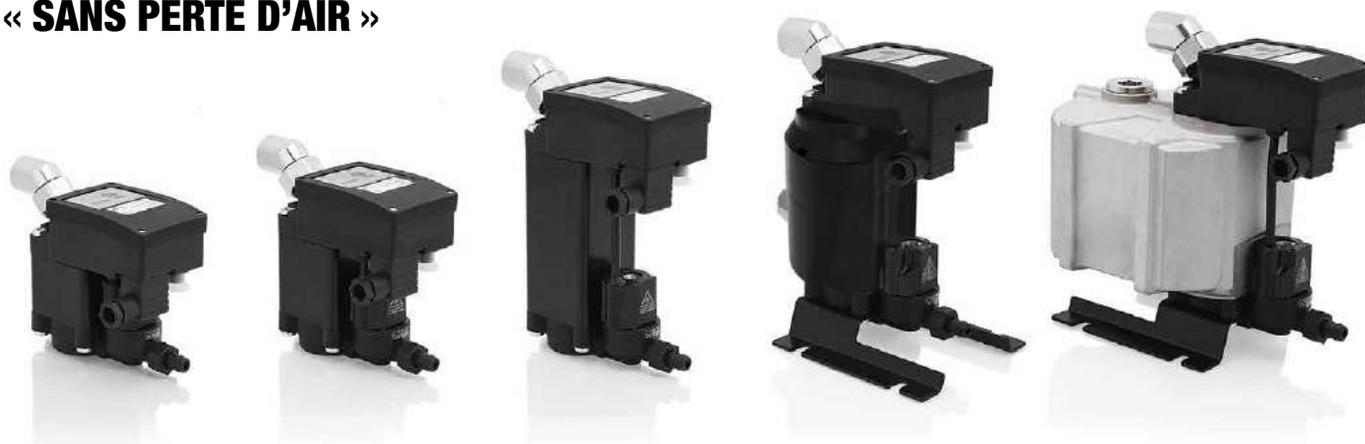
Les purgeurs automatiques **LOGIDRAIN** ont été conçus pour résoudre le problème de la purge de l'eau de condensation des usines de production et des systèmes de distribution d'air comprimé. La technologie spécifique appliquée permet une purge contrôlée d'eau de condensation sans fuite d'air comprimé.
