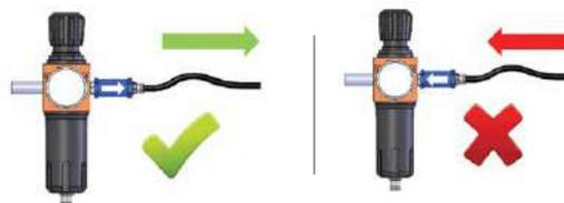
Le diamètre intérieur du tuyau à air ou du tube rigide installé avant la soupape de sécurité **HOSEGUARD®** doit être égal ou supérieur au diamètre intérieur de la soupape de sécurité **HOSEGUARD®**
